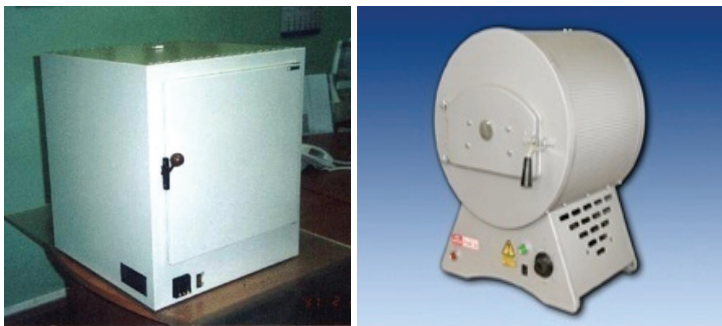
Рис. 3. Муфельная электропечь с заданной температурой
