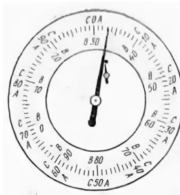
Рис.8. Циферблат прибора для проверки твёрдости по Роквеллу
